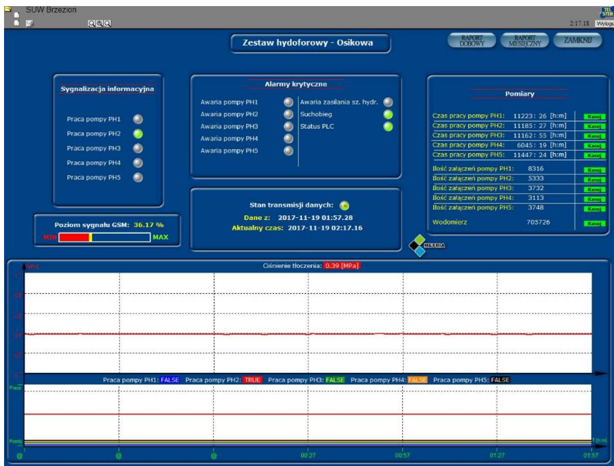
Rysunek 8 Widok okna systemu SCADA dla wybranego zestawu hydroforowego
